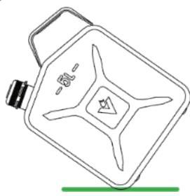
Achtung! Stellen Sie durch Kippen des Kanisters sicher, dass der Kanister nach jedem Gebrauch luftdicht verschlossen ist
