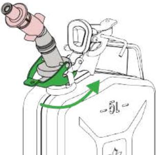
Schieben Sie den Haken mit den Haken des Bajonett-Verschlusses in die seitlichen Halterungen der Öffnung. Danach drücken Sie den Verschluss vollständig bis zum Anschlag herunter.
