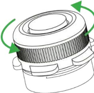
Schrauben Sie den Deckel des Kanisters gegen den Uhrzeigersinn auf.
