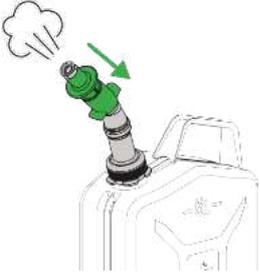
Öffnen Sie durch Drücken den Verschluss des des Ausgießers, um den Druck im Kanister auszugleichen.
