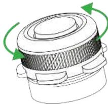
Schrauben Sie den Deckel des Kanisters gegen den Uhrzeigersinn auf.
