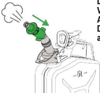
Öffnen Sie durch Drücken den Verschluss des des Ausgießers, um den Druck im Kanister auszugleichen.
