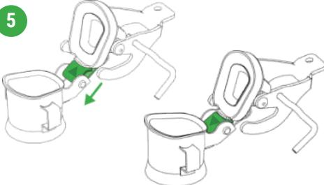
Schieben Sie das Scharnier nach unten, damit der Deckel in der Position gehalten wird.
