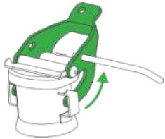
Heben Sie den Deckel an, bis die Haken des Bajonett-Verschlusses vollständig aus den seitlichen Halterungen gedreht sind.
